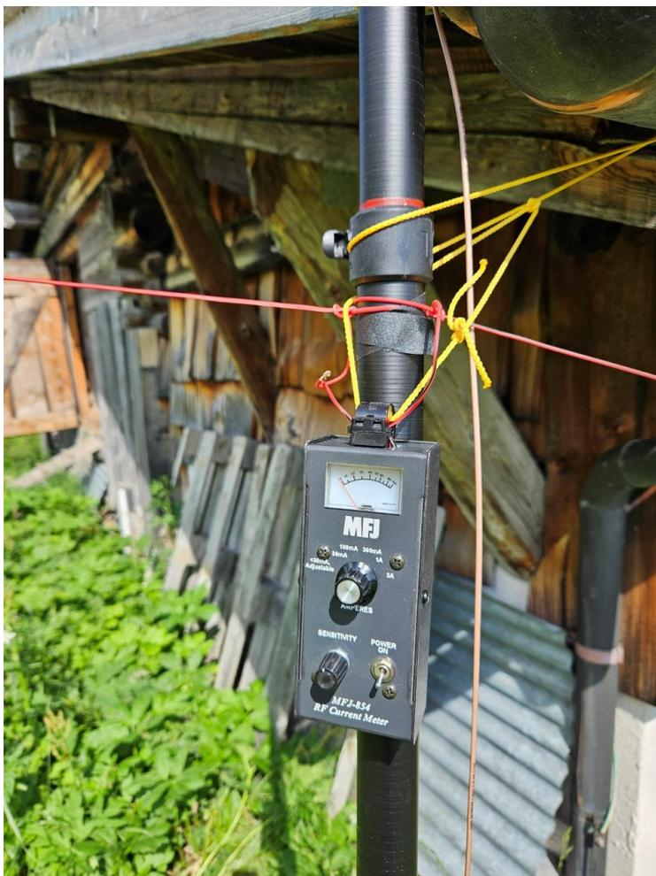
GND-Draht wurde abgestimmt auf max. Strom von ca. 150 mA bei 5 W TX-power (IC-705 mit 7.2 V Akku) (gemessen mit HF-Amperemeter MFJ-854)
