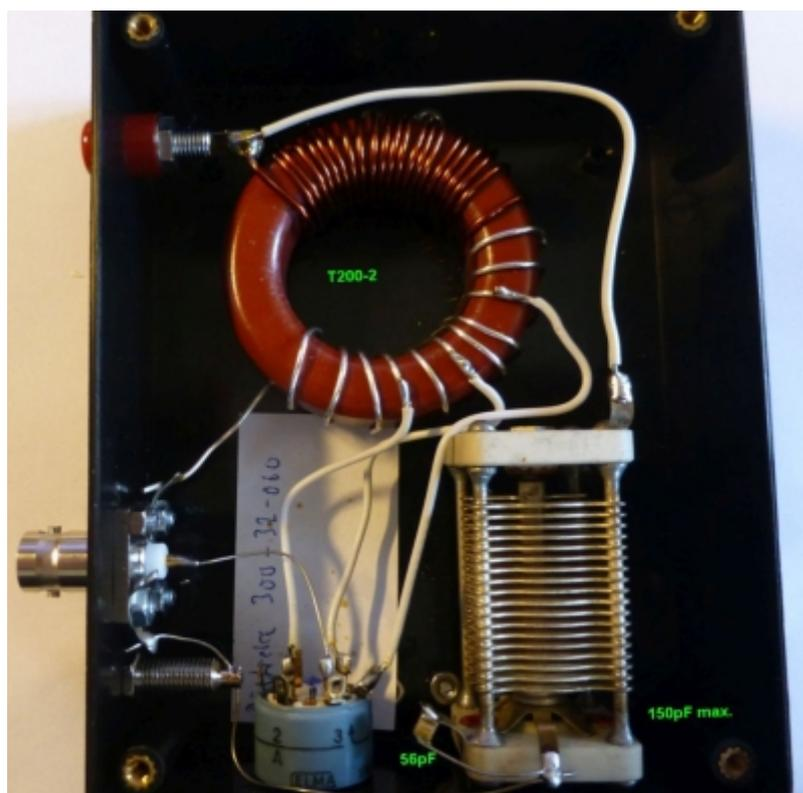
*Fig. 5 Am NMD 2022 von HB3YMQ/p eingesetzter EFHW-Tuner gemäss Fig. 3, mit drei wählbaren Anzapfungen*
