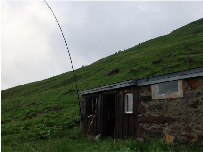
Die Antenne könnte ich direkt an der Hütte mit Zugbändern befestigen. Der Mittelpunkt des Dipols war etwa 8m über Boden.
