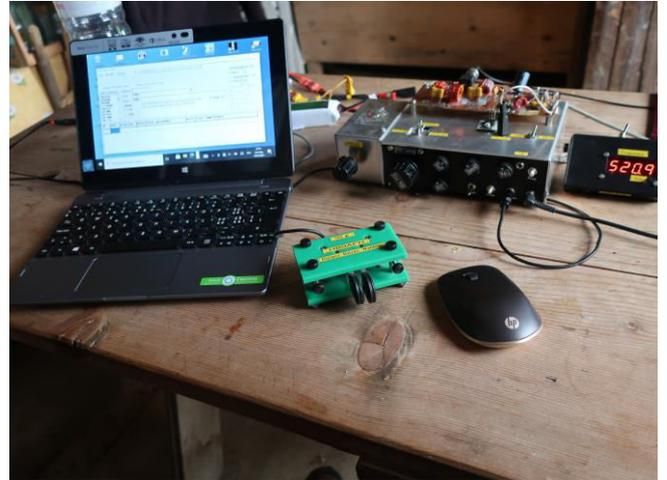
Die Station in der oberen Sennhütte eingerichtet. Das Logbuch wurde elektronisch geführt. Auch die grüne Distanz-Bolzen-Morsetaste wurde einmal für den NMD gebaut. Oben auf dem Gehäusedeckel eine Klasse-E Endstufe, die bis zu 60W Leistung bei grossem Wirkungsgrad auf die Antenne abgeben kann. Das NMD-Gesamtgewicht war 4.1 Kg.
