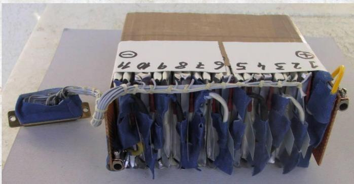
Konfektionierte Batterie 2: 11S2P mit Messleitung über 1 kOhm an jede Zelle
